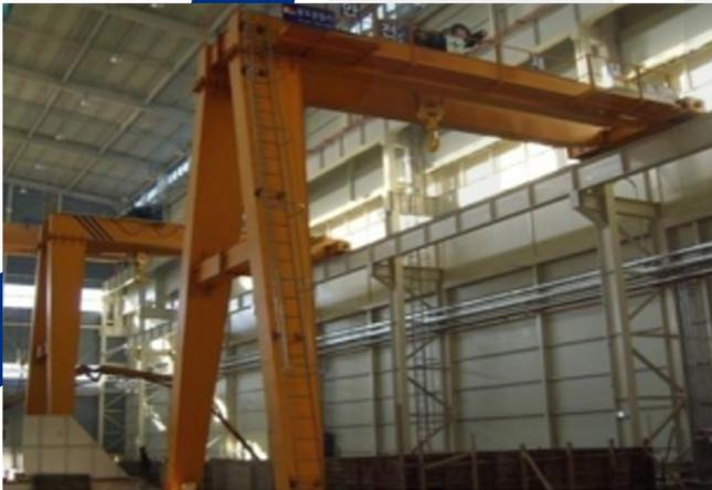
지면의 주행레일 위에 1개의 교각을 설치하고, 나머지 1개는 건물 외벽 등 구조물을 이용하여 레일을 만드는 형태로서 "ㄱ"모형을 한 형태의 크레인을 말합니다.
